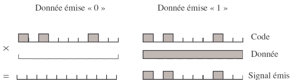
Figure 129 : Illustration du codage d'un bit en DS-OCDMA avec un code unipolaire de longueur 10 et de poids 3 [102]
