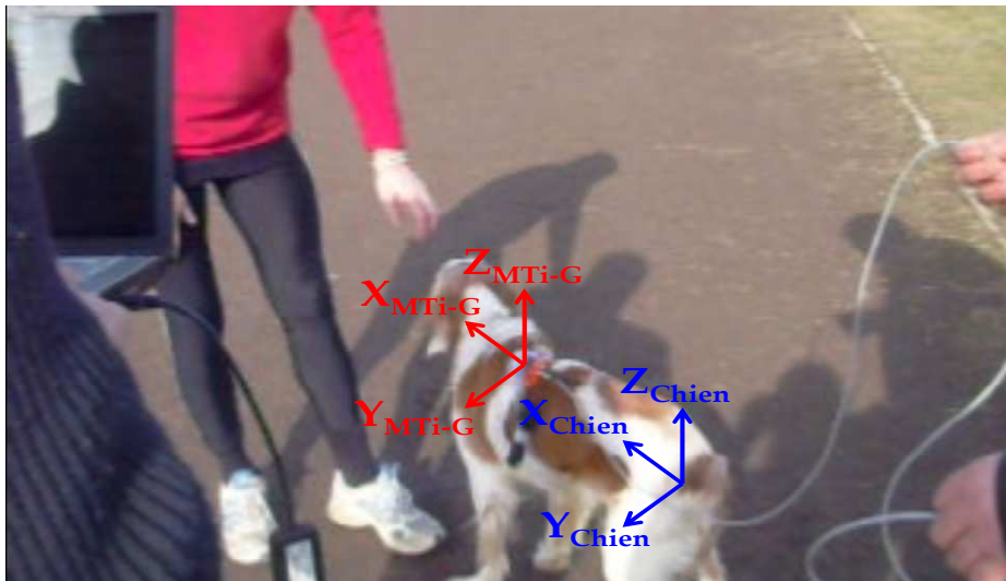
Fig. 4.17. La centrale inertielle MTi-G attachée au dos du chien
