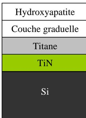
Figure 3.4.1. Vue schématique de l’organisation des échantillons utilisés
