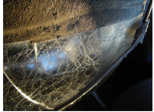
FIG. (II) 1.2: Photographie d'un OM de la ligne 6 [img26]. L'effet de « verre brisé » correspond aux « biosalissures », et de la sédimentation est visible sur le ruban adhésif. Cet OM est un cas extrême : les biosalissures observées sur les autres OMs sont moins importantes.
