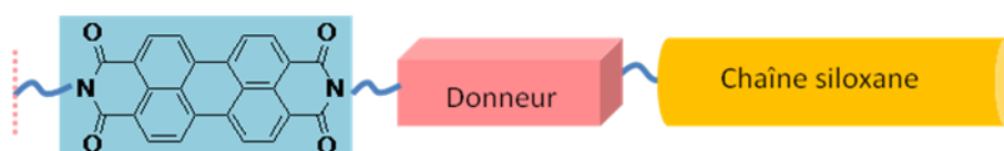
Figure II-2 : Le pérylène diimide constitue le groupe accepteur dans les trois systèmes DAD.
