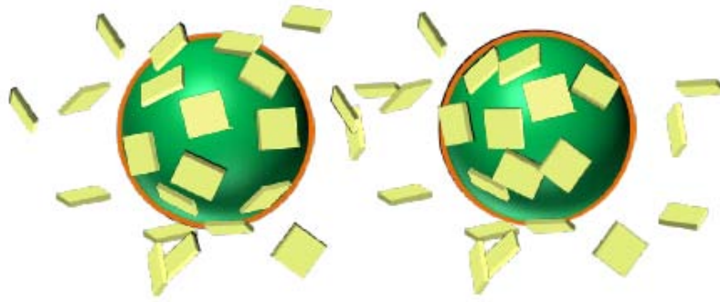
Figure 141 : Représentation schématique de la morphologie visée de particules nanocomposites polymère/montmorillonite ou polymère/Cloisite 30B
