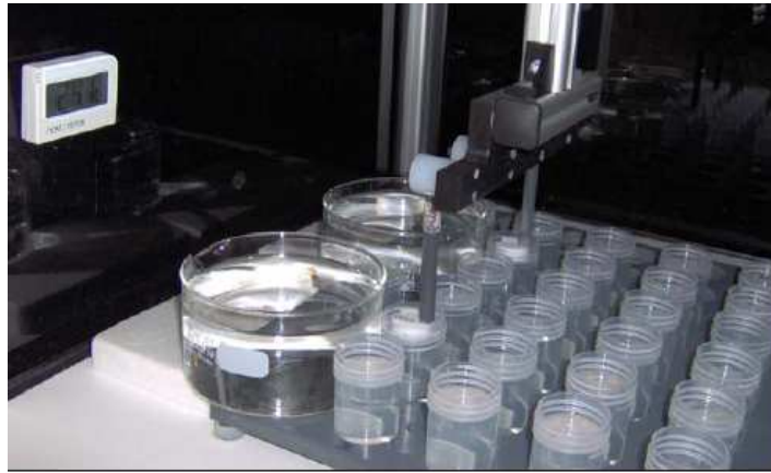
Figure 2.1. Construction d'un film multicouche par trempage.
