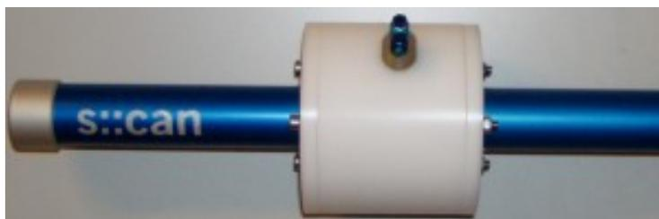
Fig. 6.24 – Insert permettant un mesure spectrophotométrique en by-pass
