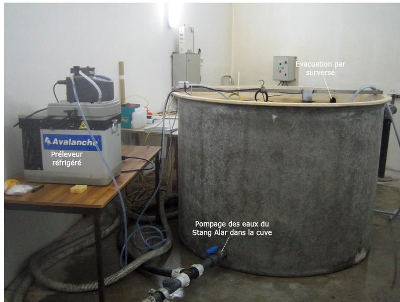
Fig. 6.3 – Photo du dispositif expérimental installé dans la station de pompage de Palaren (Brest)
