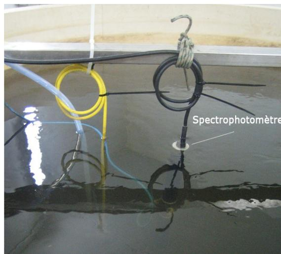
Fig. 6.5 – Spectrophotomètre immergé dans la cuve de mesure
