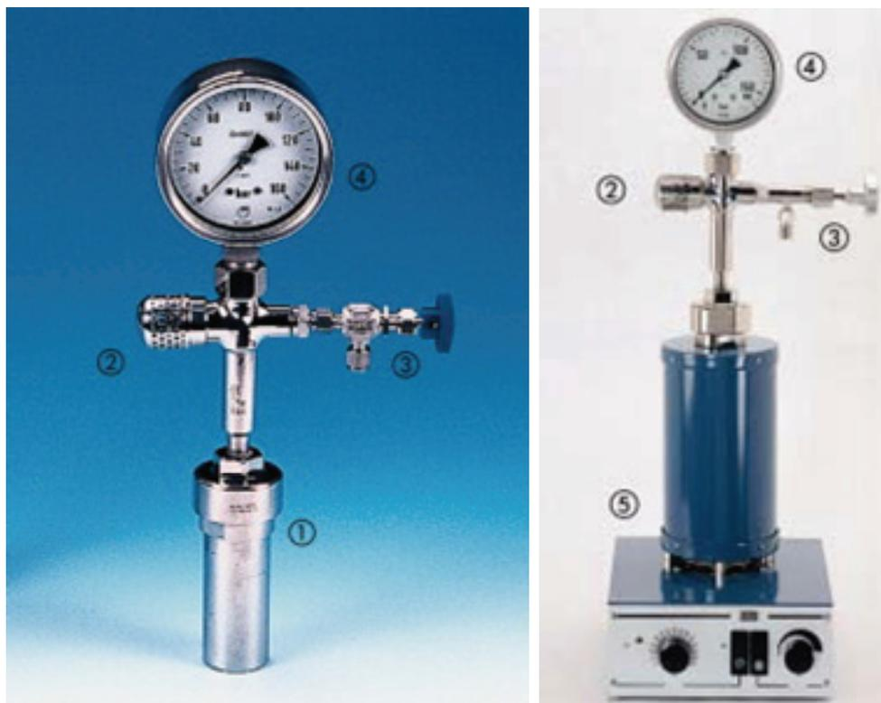
Figure II - 5 - Photo de l'autoclave complet à gauche et de l'ensemble du montage de chauffage et d'agitation de l'autoclave à droite cf. [http://www.fr.carlroth.com/media/\\_fr-fr/Graphics/00033142\\_0.jpg](http://www.fr.carlroth.com/media/_fr-fr/Graphics/00033142_0.jpg) et [http://www.fr.carlroth.com/media/\\_fr-fr/Graphics/00013860\\_0.jpg](http://www.fr.carlroth.com/media/_fr-fr/Graphics/00013860_0.jpg)
