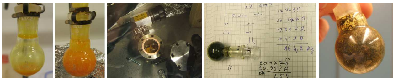
Figure 5.14: Cp_2Ti(CH_3)_2 dilué ; Préparation pour la source ; Installation dans la chambre MIVOC ; Produit oxydé de retour de l'accélérateur. / Cp_2Ti(CH_3)_2 diluted ; Preparation for the source ; Installation in the MIVOC chamber ; Oxidized product coming back from the Cyclotron ECR source head.
