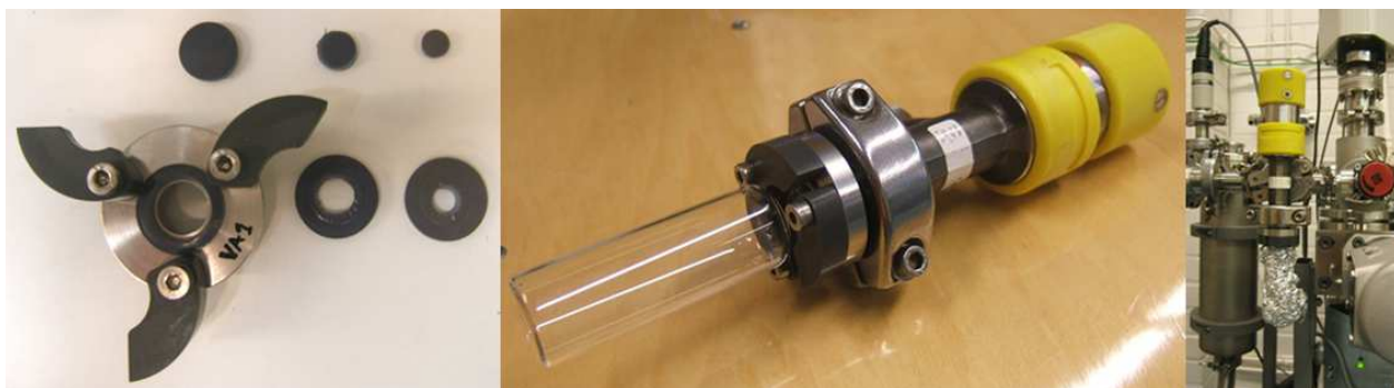
Figure 5.15: a. Système fixation des fioles sur la vanne. b. Nouvel adaptateur à vide monté sur la vanne micrométrique. c. test sur le spectromètre de masse QMS. / a. Adaptor for the vials on the valve. b. Adaptor mounted on a micrometric valve. c. Test on the QMS mass spectrometer.
