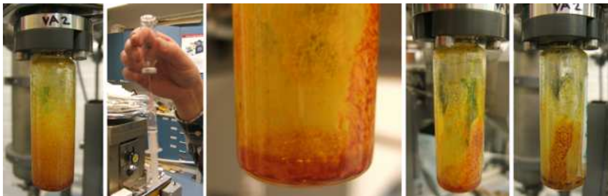
Figure 5.19: Test de Cp_2Ti(CH_3)_2 dans du liquide ionique : Produit sec ; Liquide ionique dans le seringue et 3 vues du Cp_2Ti(CH_3)_2 du ressolubilisé dans du liquide ionique. On constate des éclaboussures dues à des bulles dans le liquide ionique. / Test of Cp_2Ti(CH_3)_2 in ionic liquid : Dry product ; Ionic liquid in syringe ; 3 different views of Cp_2Ti(CH_3)_2 diluted in ionic liquid. Bubbles appeared in the ionic liquid.
