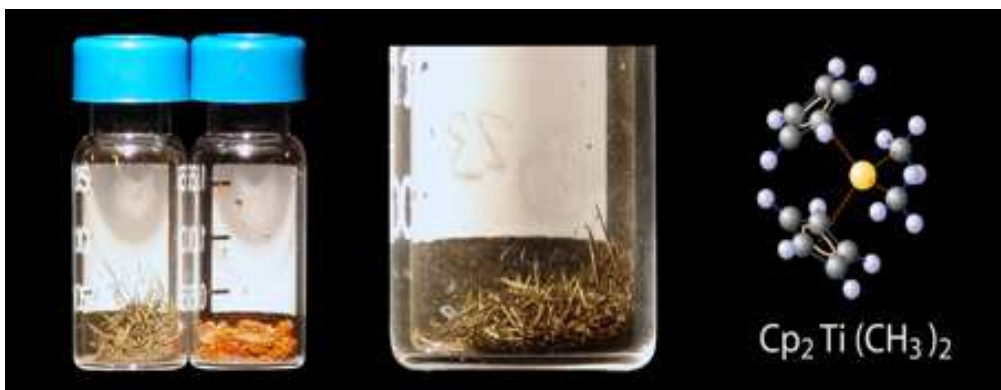
Figure 5.11: Résultat de la première synthèse de Cp_2Ti(CH_3)_2 effectuée en 2004 en collaboration avec l'ITC/ITU de Karlsruhe. Dans le flacon du centre le résidu sec de purification (orange) entouré de deux vues des cristaux secs de Cp_2TiMe_2 . / Results of the first synthesis of Cp_2Ti(CH_3)_2 performed in collaboration with the ITC/ITU Karlsruhe. The purification residue is in the center vial (orange), surrounded by pure crystallised product (samples left and right).
