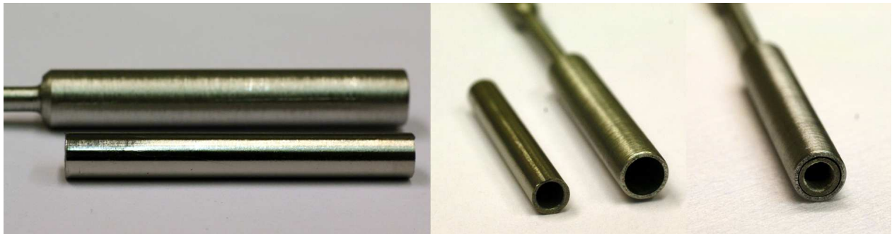
Figure 5.4: Four en molybdène et creuset à côté ou inséré. (Photo M. Savonen) / Molybdenum oven with the Tungsten crucible (Picture M. Savonen)
