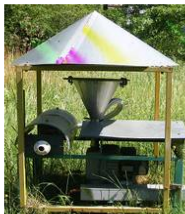
Figure I.2 : Schéma et photo d'un système d'échantillonnage à grand volume (installé au jardin botanique à Strasbourg, France)
