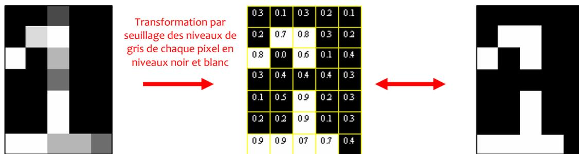
Figure 3-3 Représentation matricielle du chiffre 1 bruité.
