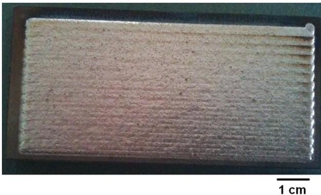
Figure i-10 - Surface rechargée par laser (dépôt NiCrBSi, substrat acier C38).
