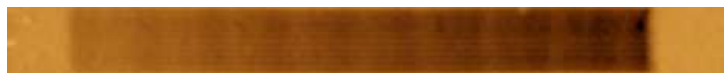
FIG. 3.18 – Image de génération de second harmonique de 9 niveaux de gris (+1) représenté par la zone non inscrite) obtenus en faisant varier l'intensité de 0 à 0.85 s
