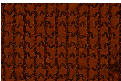
FIG. 4.15 – Déformation de l'inscription suite à un chauffage trop intense.
