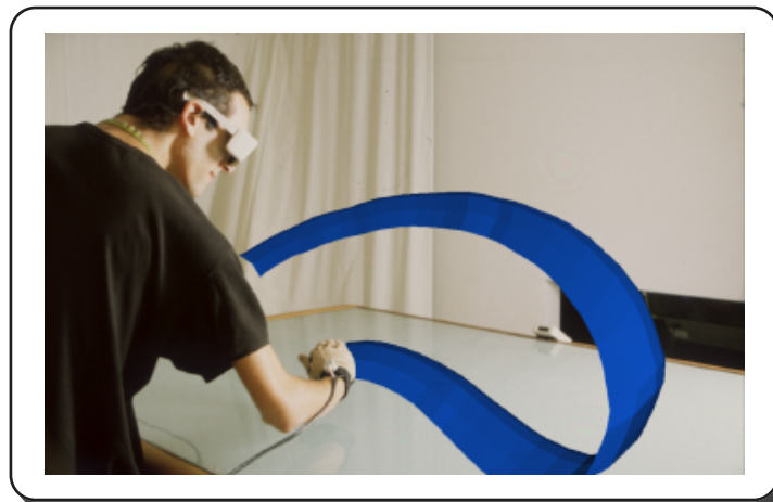
FIGURE 1.4 – L'utilisateur crée une surface 3-D en manipulant un pinceau 3-D à l'aide d'un gant de donnée. Image extraite de [Schkolne 01].
