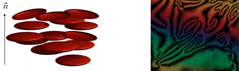
Figure I.3.1.b. Représentation schématique de l'arrangement des molécules dans une phase nématique discotique 26 (gauche) – Photographie d'une phase nématique discotique 30 (droite)
