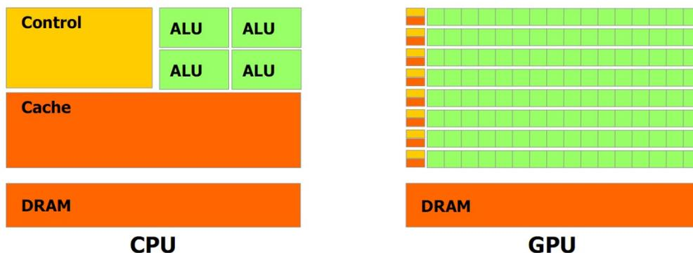
FIGURE 4.6 – Comparaison schématique entre architecture CPU et GPU [NVI11].
