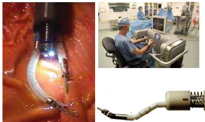
FIG. 1.17 – Système endoscopique ViaCath de la société EndoVia à gauche, console maître de Laproteck en haut à droite et nouvelle génération d'instrument articulé en bas à droite
