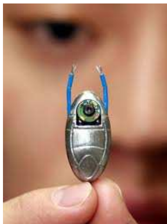
FIG. 1.22 – Robot miniature pour la thérapie endoluminale de l'université de Ritsumeikan au Japon
