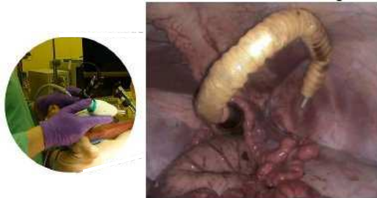
FIG. 1.16 – Interface maître à gauche et esclave à droite lors d'un test in vivo du système développé par l'Imperial College de Londres
