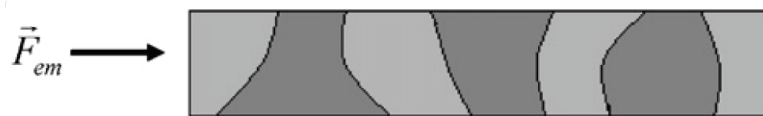
FIGURE 7.2 – Ligne métallique, où la taille des grains est comparable à la largeur de la ligne : Structure type bambou
