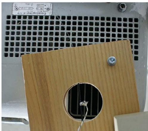
Figure 5-15 : Montage expérimental pour mesurer la constante de temps du transducteur en convection forcée
