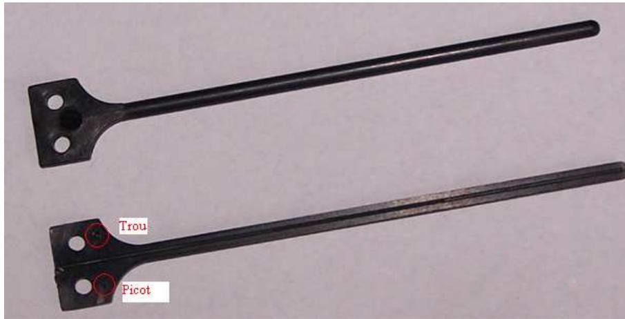
Figure 4-8 : Mâchoire en PPS réalisées par injection plastique
