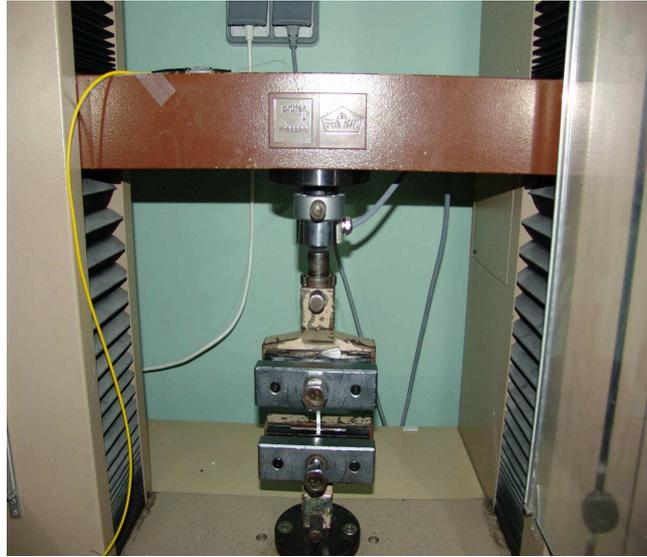
*Figure 5-19: Montage expérimental de tests des capteurs en étirement*
