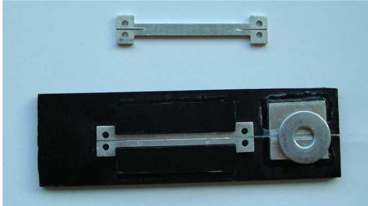
Figure 4-12 : Montage du transducteur à mâchoire en aluminium
