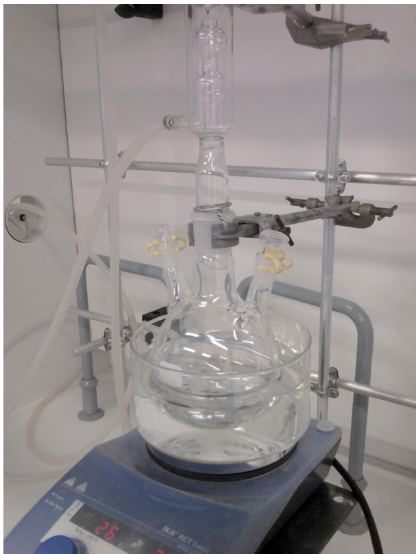
Figure II.1 : Montage et matériel utilisés pour la cristallisation du DoTAB.
