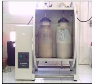
**Figure. 31:** Agitateur mécanique Heidalph REAX 20
