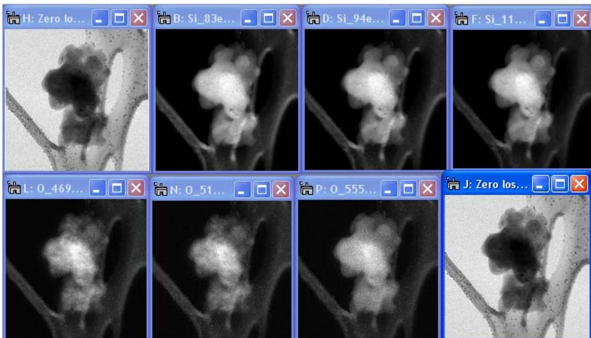
**Figure 2.11:** Séquence extraite de l'acquisition en tomographie EFTEM des séries d'images filtrées pour deux éléments d'intérêt, correspondant à un seul angle de tilt ; elle illustre les huit images qui sont utilisées dans la suite du traitement: deux images ZL, une au départ et une à la fin, et ensuite trois images filtrées (pre-edge 1, pre-edge 2 et post-edge) pour chacun des deux éléments.
