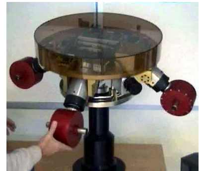
(c) Plateforme Tetragyre de l'ONERA à 3 axes actionnés par 4 gyrodynes.
