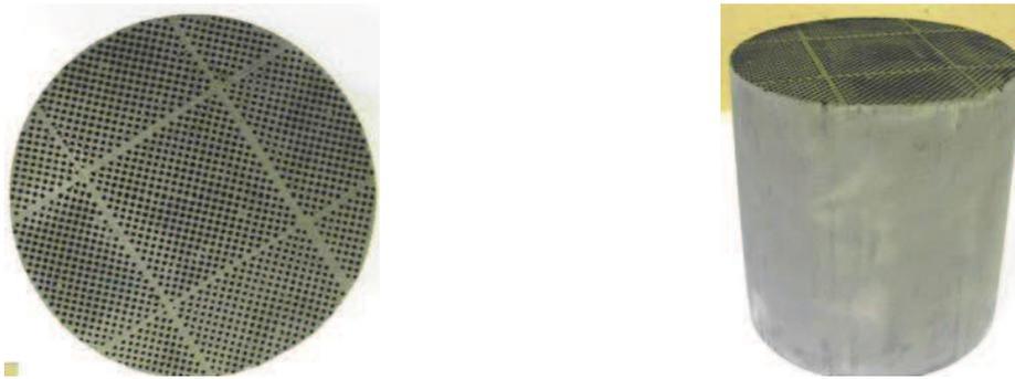
**Figure 4.3.** Schéma d'une structure nid d'abeille (canaux droits) : le catalyseur est déposé sur une couche de washcoat jouant le rôle de couche d'ancrage
