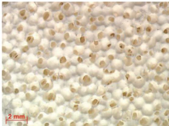
*Figure 4.8. Schéma d'une mousse céramique présentant des cellules interconnectées*
