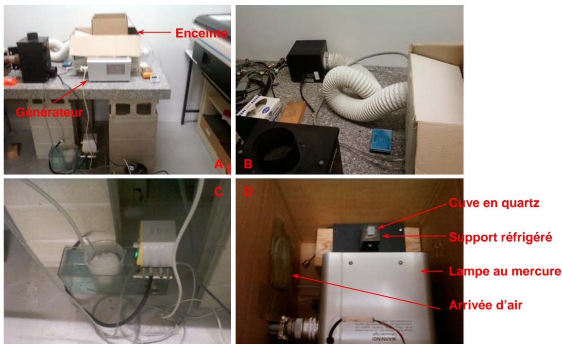
**Figure III.26 :** enceinte d'irradiation, **A** vue globale, **B** système de ventilation de l'enceinte, **C** système de refroidissement de la cuve, **D** intérieur de l'enceinte
