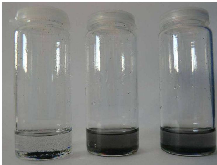
Figure 84 : test de solubilité dans le toluène pour FePc/C 60 20 % bis, FePc/C 60 20 % et FePc/C 60 37 %
