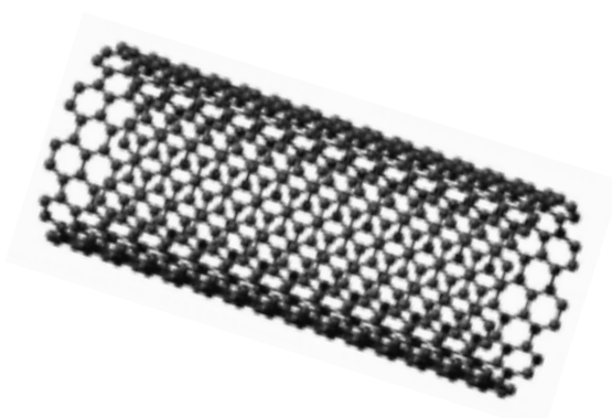
Figure 33 : schéma de nanotube monofeuillet
