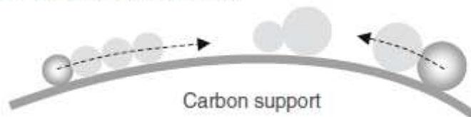
Figure 23 : schéma de la coalescence du platine par migration à la surface du carbone support 36
