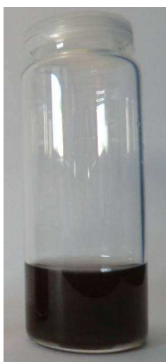
Figure 83 : test de solubilité dans le toluène pour Pt_4C_{60}
