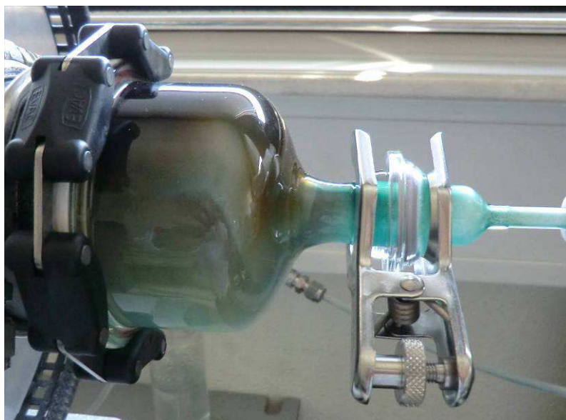
Figure 68 : dépôt vert sous le dépôt couleur rouille
