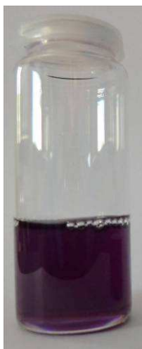
Figure 82 : test de solubilité dans le toluène pour Pt/ C_{60} 20 %
