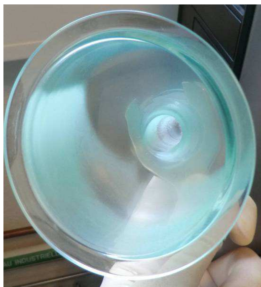
Figure 69 : dépôt vert obtenu après un temps de purge trop court
