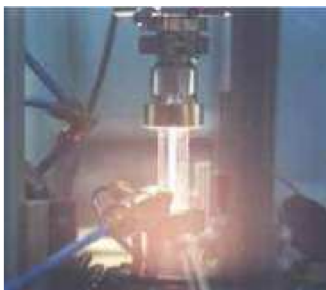
Figure 42 : ablation laser dans un réacteur de nanotubes de l'ONERA
