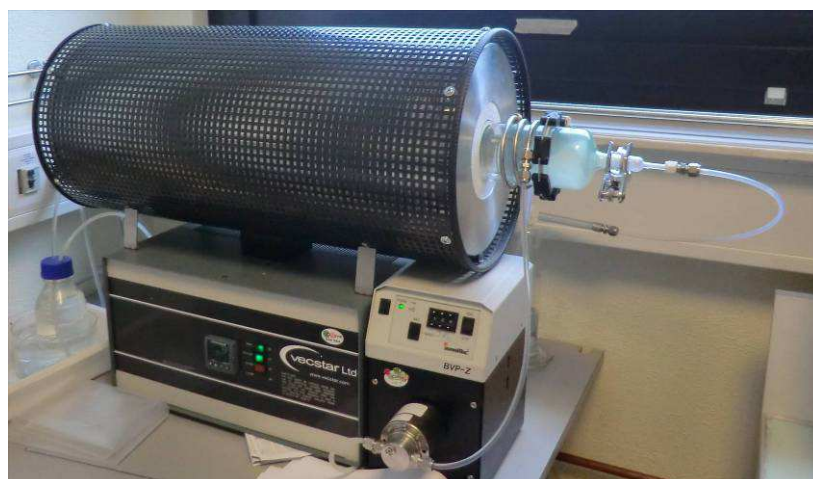
Figure 65 : photographie du four tubulaire utilisé
