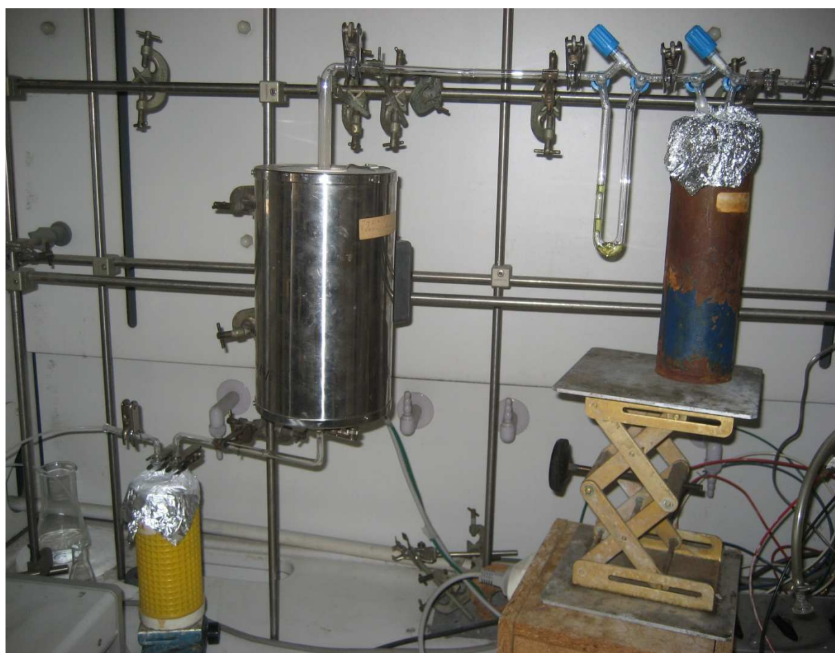
Schéma 35 : Procédé de chloration en phase solide/gaz
