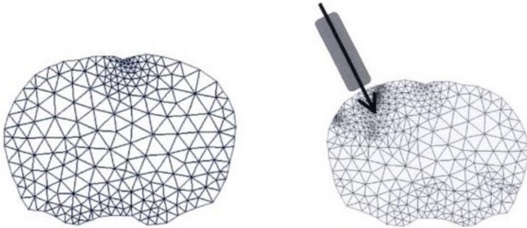
Figure 37 : Illustration du maillage (à gauche) et de la sollicitation d'impact appliquée (à droite) (Pena et al., 2005)
