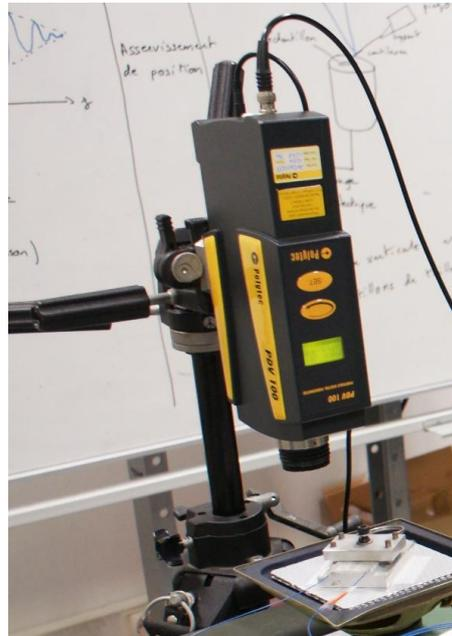
*Figure 4.2: Vélocimètre à effet Doppler de Polytec dont le faisceau laser pointe sur la membrane de l'actuateur.*
