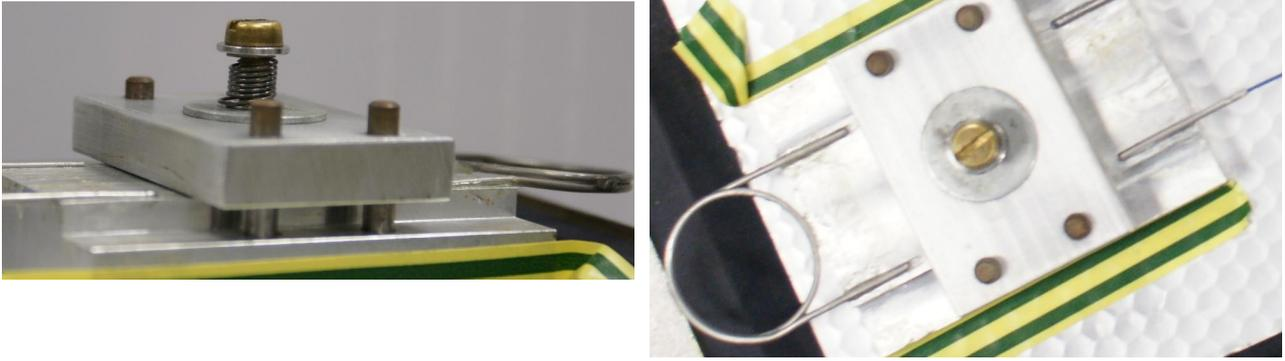
Figure 3.12: Photographies du transducteur masse-ressort-fibre optique.
