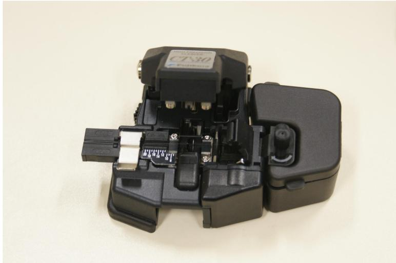
Figure 3.8: Cleaver de Fujikura utilisé pour couper de façon nette les fibres optiques.
