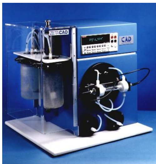
Figure 35 : Appareil permettant de mesurer le potentiel d'écoulement (LavalLab).
