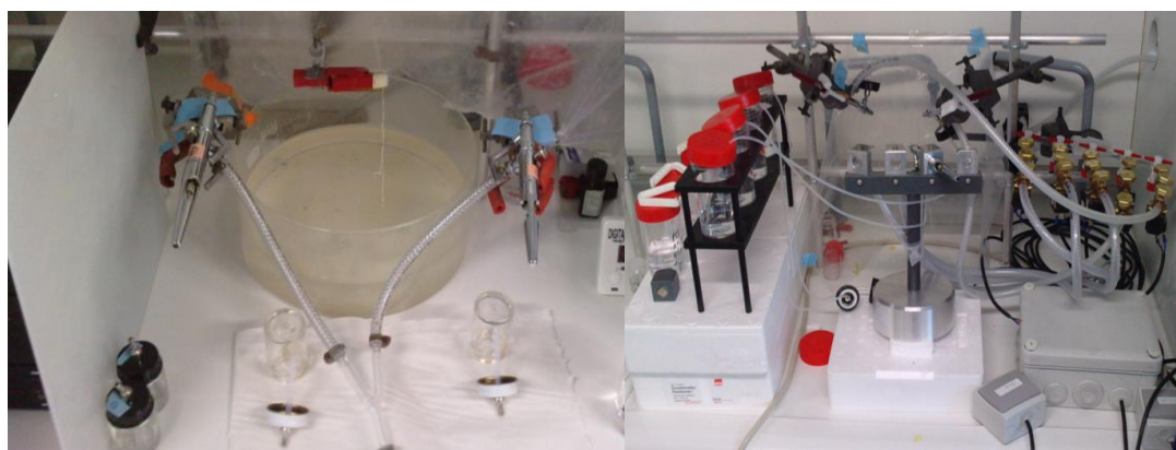
Figure 21: Montages permettant la pulvérisation dite « manuelle » à gauche et « automatique » à droite.
