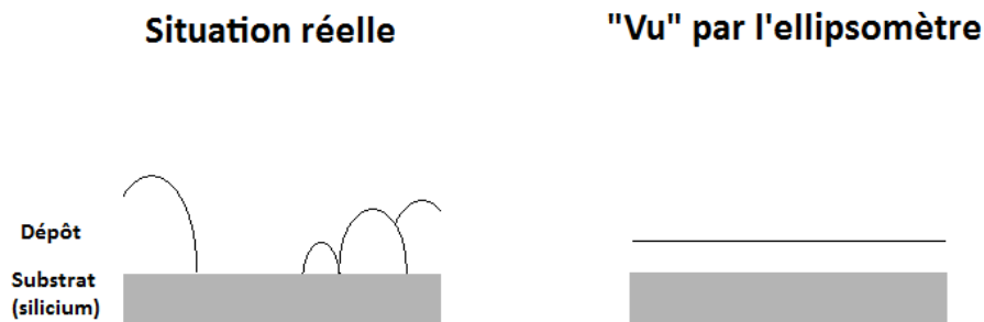
Figure 25 : Illustration de la difficulté soulevée par la mesure de l'épaisseur d'un film inhomogène en ellipsométrie.
