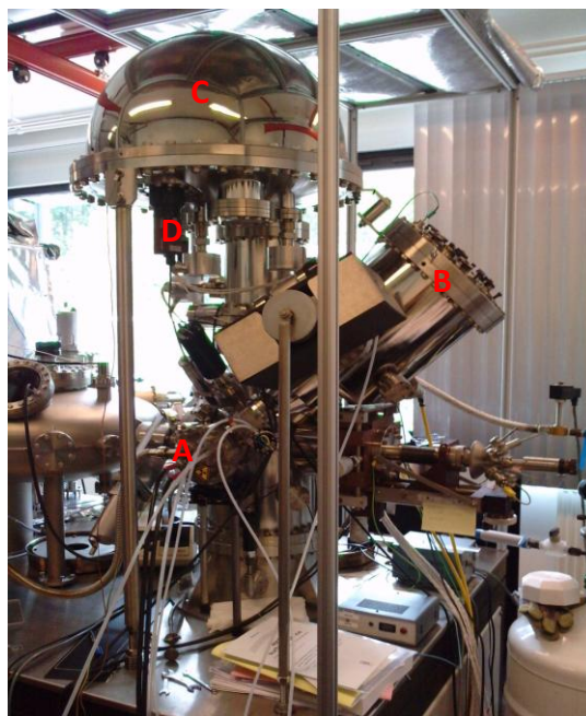
Figure 33 : Bâti ultravide permettant la spectroscopie de photoélectrons induits par rayons X (XPS) : A : cathode pour créer les rayons X, B : monochromateur en quartz placés sur la sphère de Rowland, C : analyseur, D : détecteur.
