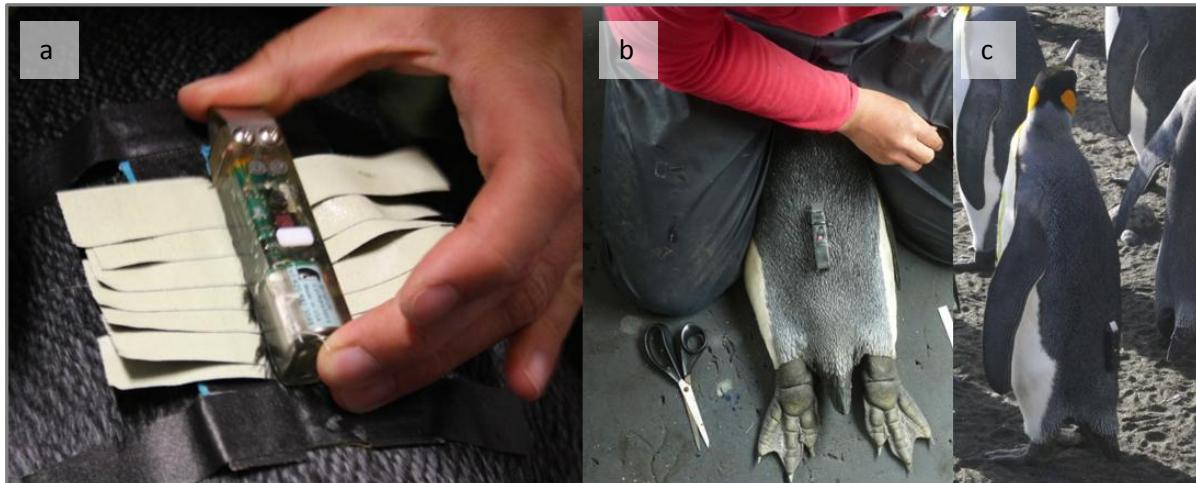
**Figure II.8 : Equipement d'un manchot d'un Mk9, Wildlife Computers.**
