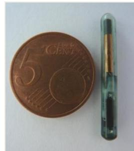
Figure II.4 Puce électronique, ou transpondeur.
