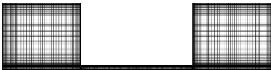
FIGURE 5.7 – Maillage - composé de 23000 cellules - utilisé pour les simulations numériques.
