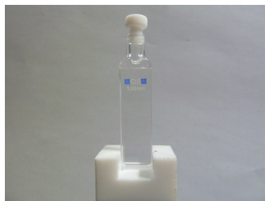
FIGURE 2.2 – Photographie de la cuve de chez Hellma , épaisseur 1 mm, volume 350 \mu\text{L} .
