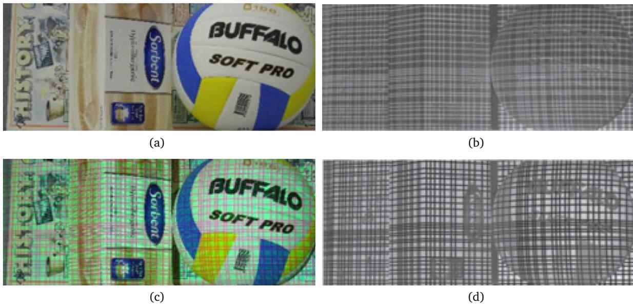
FIGURE 1.16 – Motif adaptatif dans [Li11]. a) La scène. c) Motif projeté. b) Les composantes bleue et verte de l'image. d) Troisième composante issue de l'analyse PCA extraite de l'image c).
