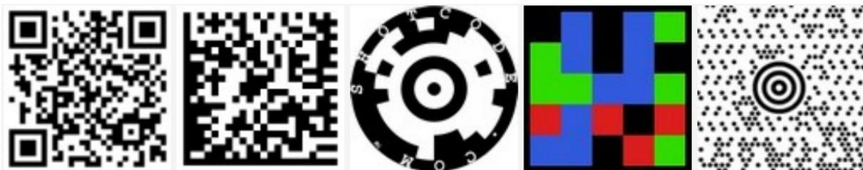
FIGURE 2.3 – Différents formats de code : Code QR, Datamatrix, Shotcode, Colorzip, Maxicode.
