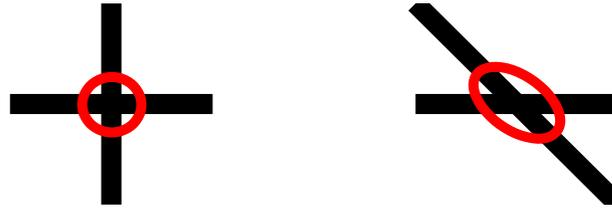
FIGURE 3.2 – Plus les franges sont orthogonales aux lignes épipolaires, plus la segmentation de leur intersection sera précise.
