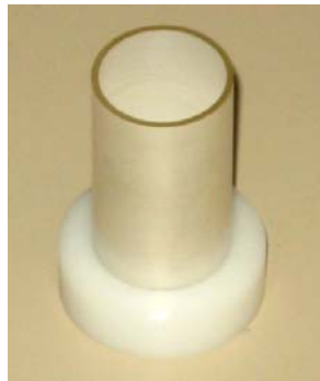
Figure 4.6 Tube piézoélectrique utilisé comme modulateur
