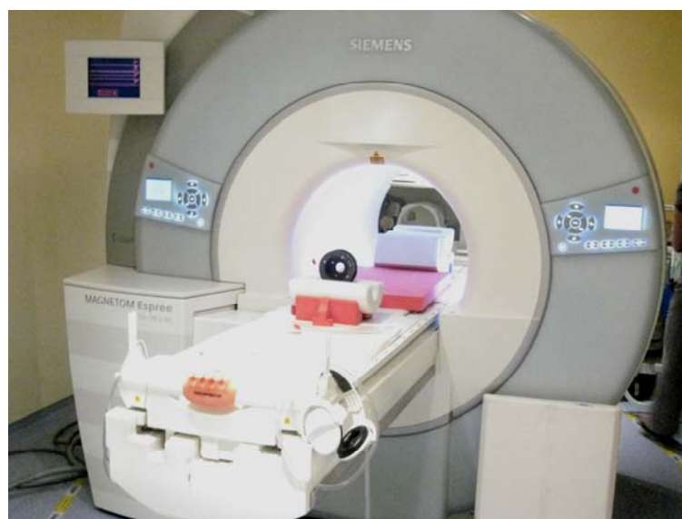
Figure 4.40 Test du gyroscope sous un fort champ magnétique de l'IRM.
