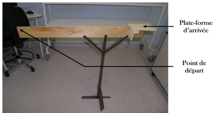
Figure 23 : Photographie illustrant le test de la barre (le matelas ne figure pas sur cette illustration).
