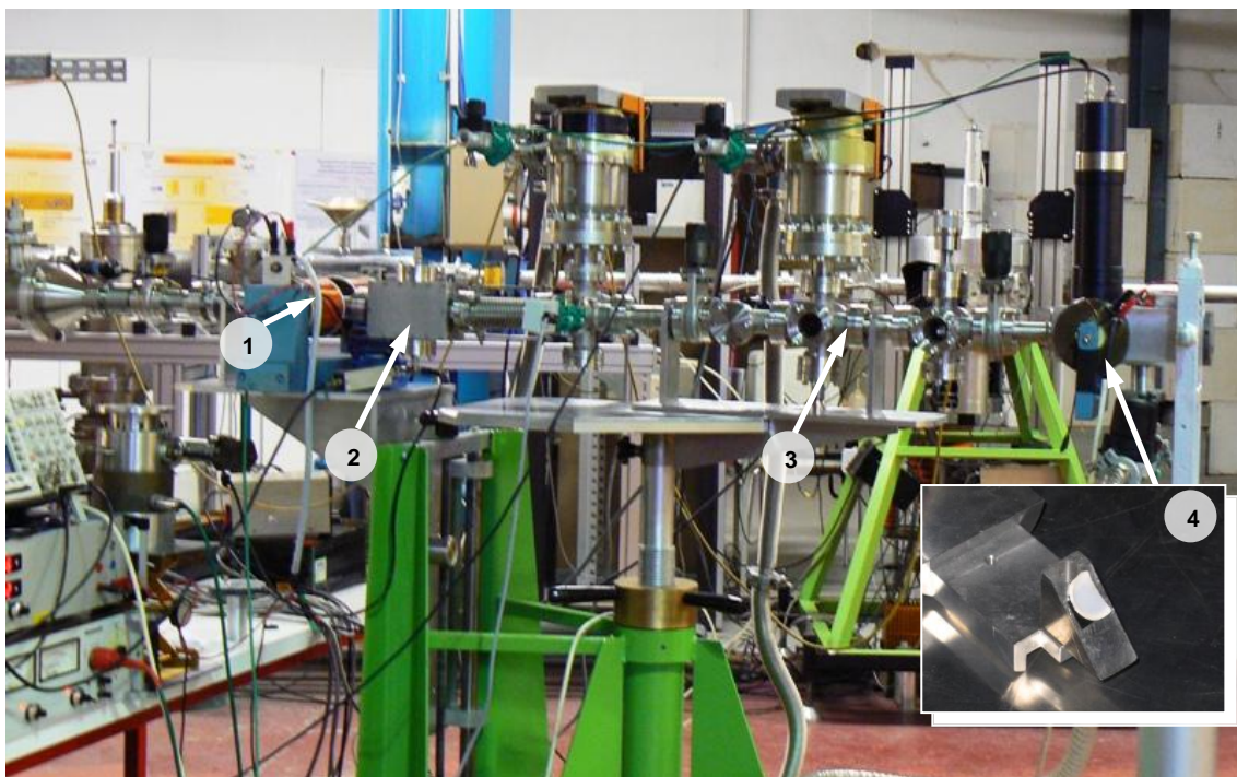
Figure 2.22 : Ligne de faisceau dédiée aux études de fluorescence (Institut d'Electronique des Solides et des Surfaces). 1 : déflexion magnétique (électroaimants), 2 : déflexion électrique, 3 : fente de sortie, 4 : chambre de détection (avec porte échantillon).
