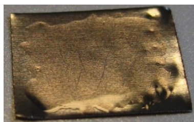
Figure 2.15 : Couche fine solide de OxP(C_8)_3-Br déposée sur un substrat de tantale ( e \approx 20\mu m ).
