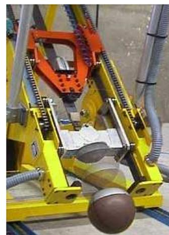
Figure 24. Exemple de modèle de jambe, modèle du TRL, et dispositif expérimental de tests d'impact de la tête.
