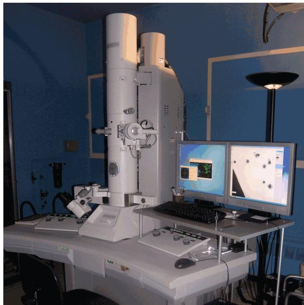
Figure 77. Microscope électronique à transmission Hitachi H7650.
