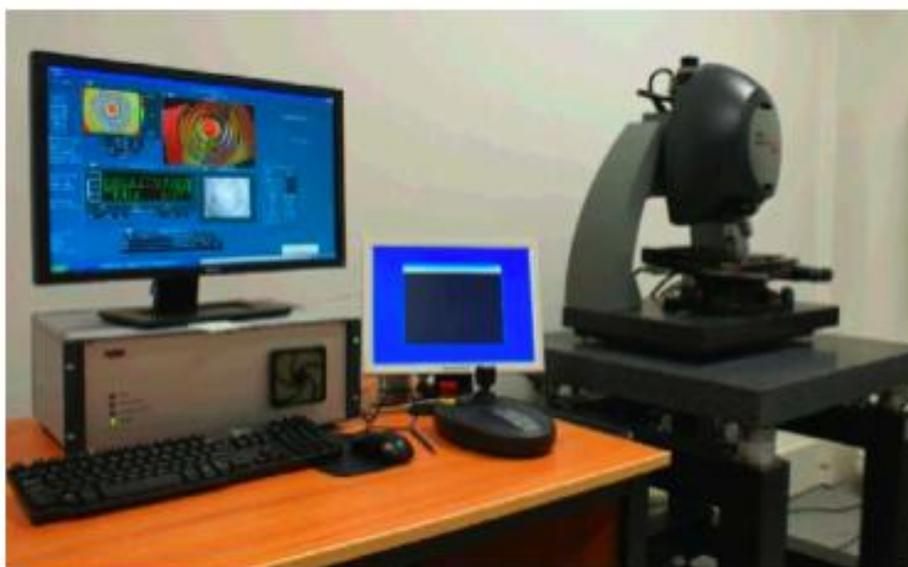
Figure 79. Photographie du profilomètre optique Zygo NewView 7200.
