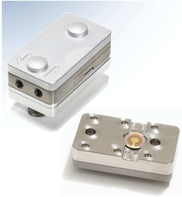
Figure 2.17 : photographie du module Q-Sense Flow module 401. La vue de gauche correspond à une vue extérieure. Celle de droite correspond à une vue du module ouvert. On y voit la face préservée du cristal équipé d'électrodes. L'autre face du cristal, non visible ici, est celle qui reçoit les dépôts.
