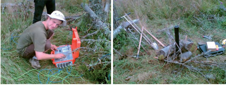
FIGURE 3.1 – gauche : Centrale d’acquisition Metronix (ADU07), droite : sonde magnétique à induction MFSO6 (fabrication Metronix)
