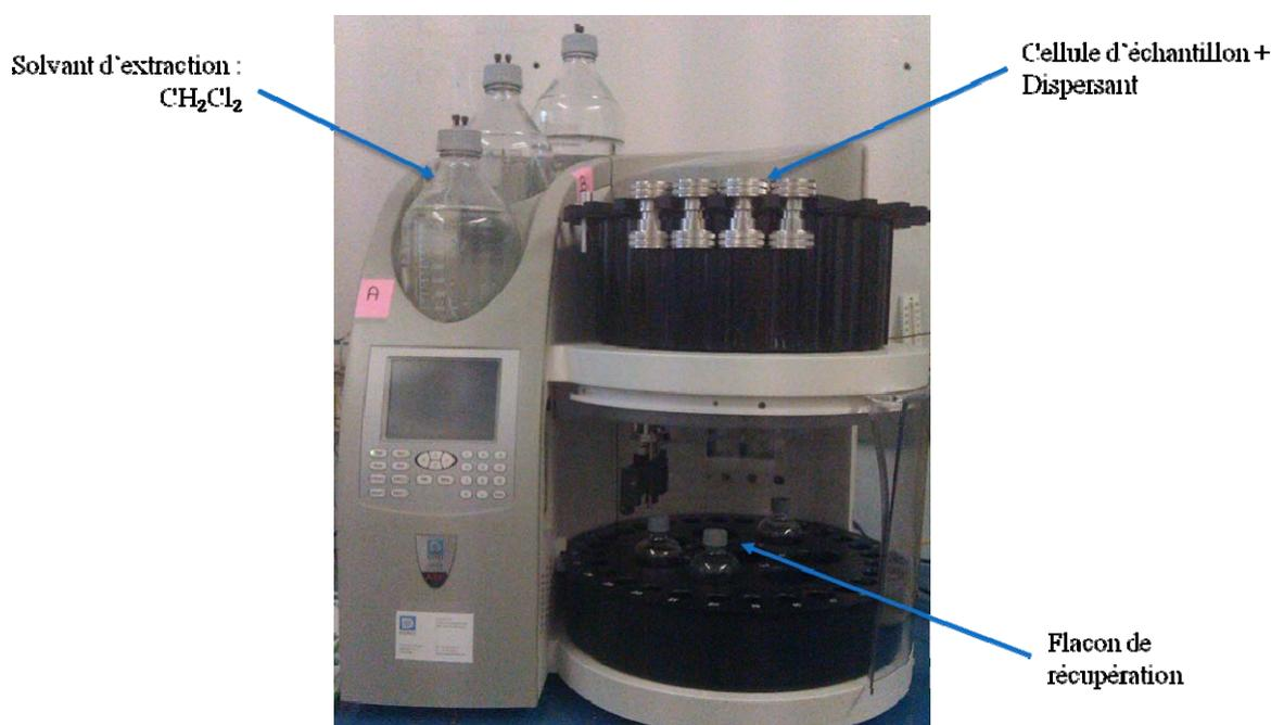
Figure 21 : Extracteur par Solvant pressurisé, ASE 350
