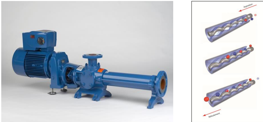
Figure 3.4 Schématisation du fonctionnement d'une pompe volumétrique
