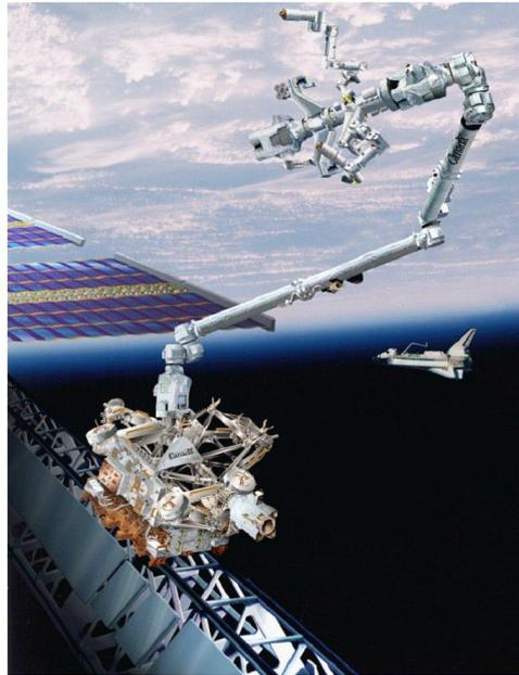
FIGURE 1.5 – Robot spatial Canadarm à longs segments conçu par la CSA
