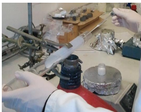
Figure 71. Dépôt sur réacteur en pyrex par évaporation du solvant.
