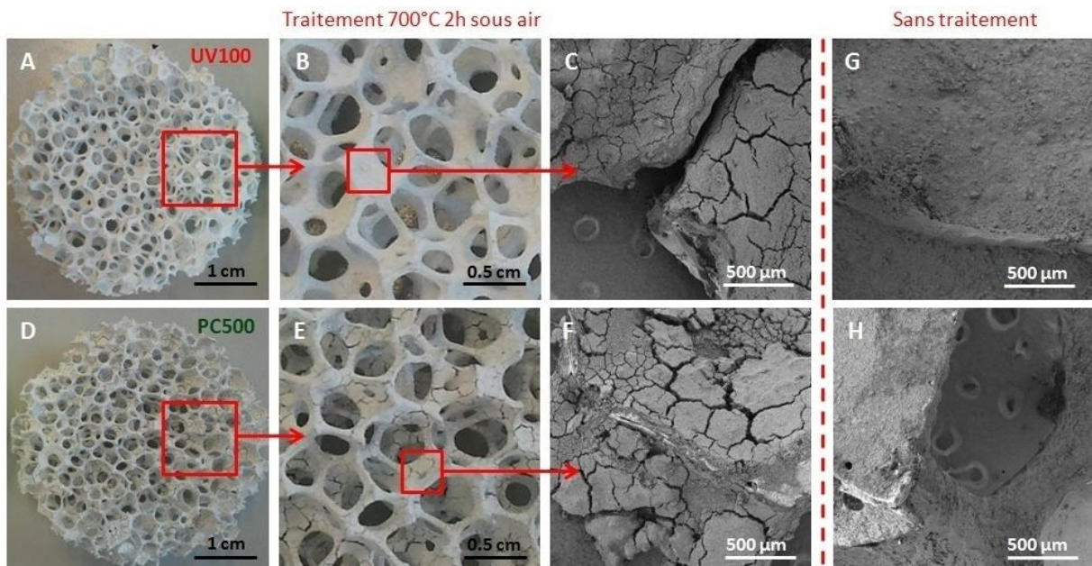
Figure 165. Aspect des revêtements de \text{TiO}_2 UV100 et PC500 sur mousse de \beta\text{-SiC} ( 5400\ \mu\text{m} ) avant (G-H) et après (A-F) traitement à 700^\circ\text{C} sous air durant 2h.
