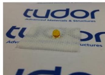
**Figure 76:** Photographie de gouttes d'eau déposées sur différents substrat après le dépôt d'un film superhydrophobe
