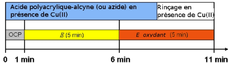
FIGURE 3.2 – Protocole de construction d'une multicouche de polymères réticulée par chimie click électrocontrôlée.
