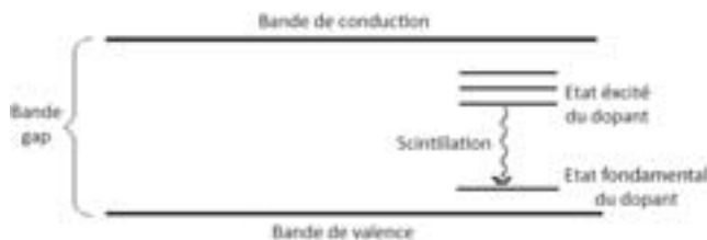
Fig. 2.23 – Diagramme représentant les états énergétiques introduits par un dopant [Knoll 10].
