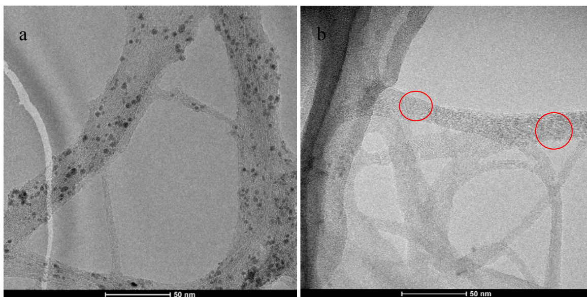
Figure 27 : Images MET de nanotubes de carbone (a) bruts et (b) purifiés.
